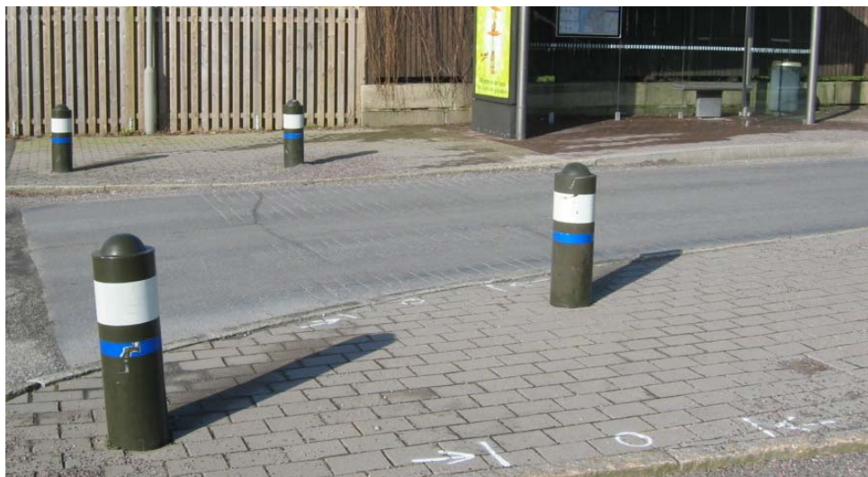
Pollarna vid hållplats Kaprifolgatan fungerar som riktningsgivare tvärs körbanan. Den mörkgröna färgen kontrasterar mot markbeläggningen.
