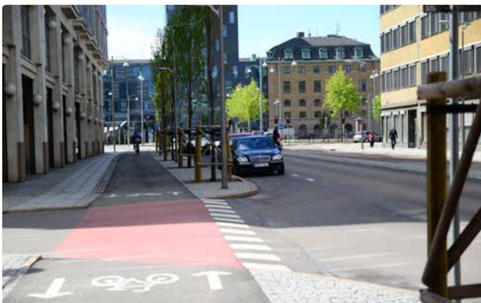
Vanlig utformning idag vid separering mellan fotgängare och cyklister. Separeringen hade varit bättre om raden med träd placerats mellan gående och cyklister.
